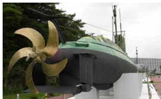
Рис. 1. Соосный винт и кормовое оперение ПЛ КНДР. Фото с сайта http://forums.airbase.ru
