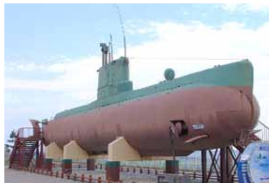
Рис. 2. ПЛ в музее Gangneung Unification Park (Ю. Корея) Видны носовые рули по туннелю пр. 205
